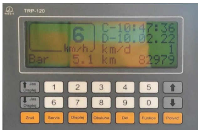
Obr. č. 5: Základní zobrazení displeje rychloměru TRP-120 na 1. stanovišti HDV 770 529-6
