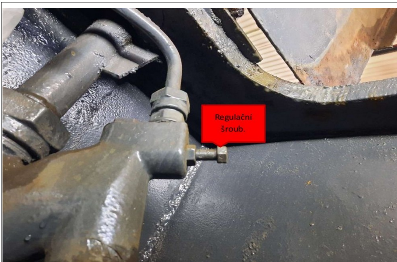
Obr. č. 22: Regulační šroub 6L pískovače a jeho umístění
