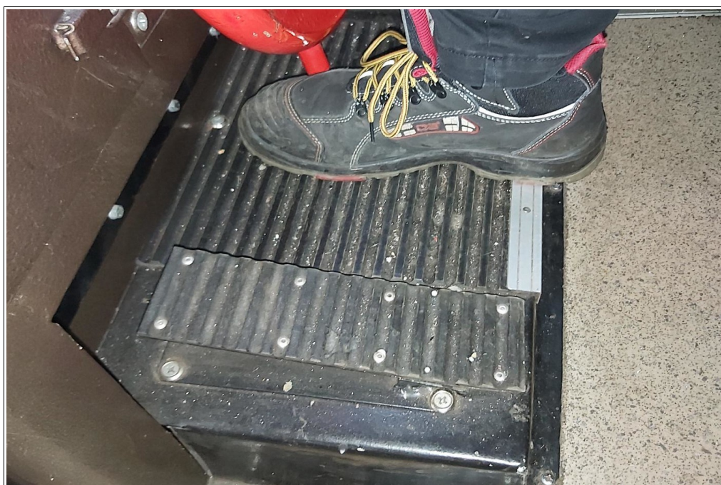
Obr. č. 8: Pohled na pedál pro pískování 2. stanoviště HDV 770 529-6
