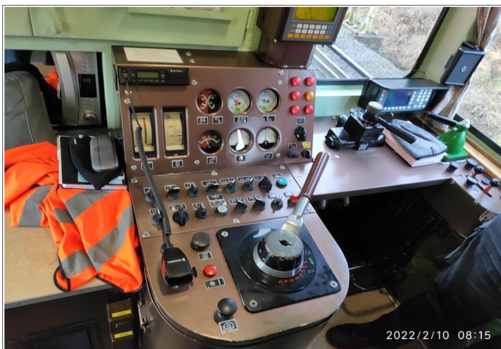
Obr. č. 9: Pohled na ovládací pult a displej rychloměru TRP-120 na 1. stanovišti HDV 770 529-6 Zdroj: DI
