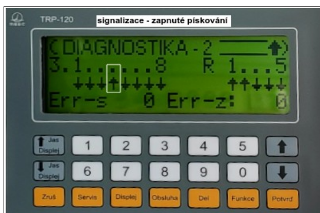
Obr. č. 6: Zobrazení diagnostiky (včetně pískování) na displeji rychloměru TRP-120 na 1. stanovišti HDV 770 529-6
