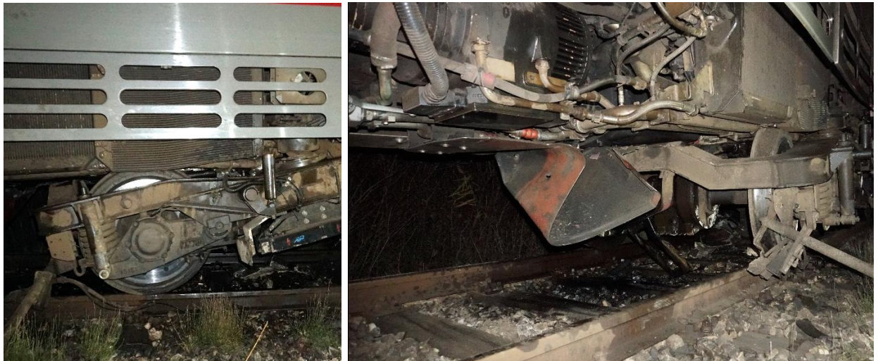
Слика 4.1.5: Изглед оштећења на погонској групи ДМВ 711-078
