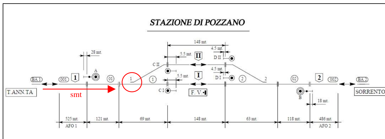
Figura 04: Piano schematico della stazione di Pozzano con indicazione del punto di svio, avvenuto in corrispondenza del deviatoio n. 1 (fonte EAV, elaborazione Ufficio).
