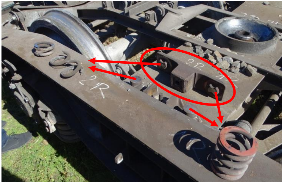
8. ábra: kiszerelt csúszótám a törött rugóival
