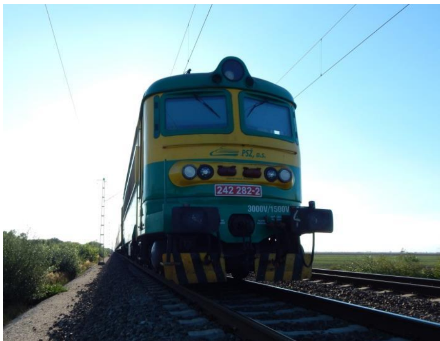
17. ábra: a vonatot továbbító mozdonyon nem volt visszapillantó tükrök
