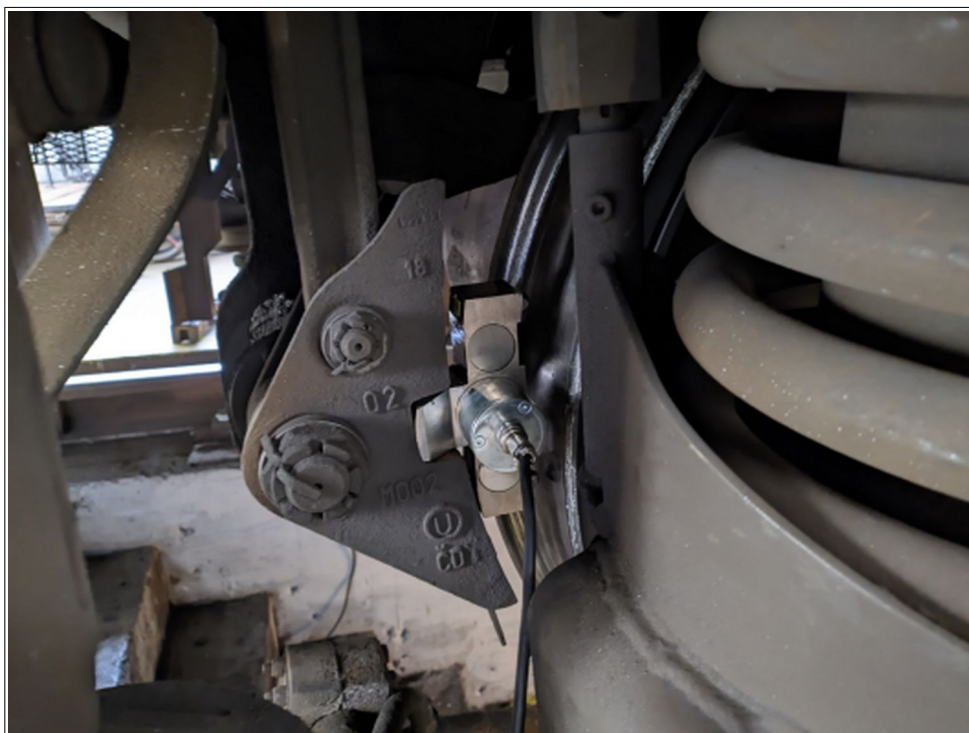
Obr. č. 6: Pohled na snímač síly (měrný špalík) použitý při měření přitlaku k jízdním plochám kol
