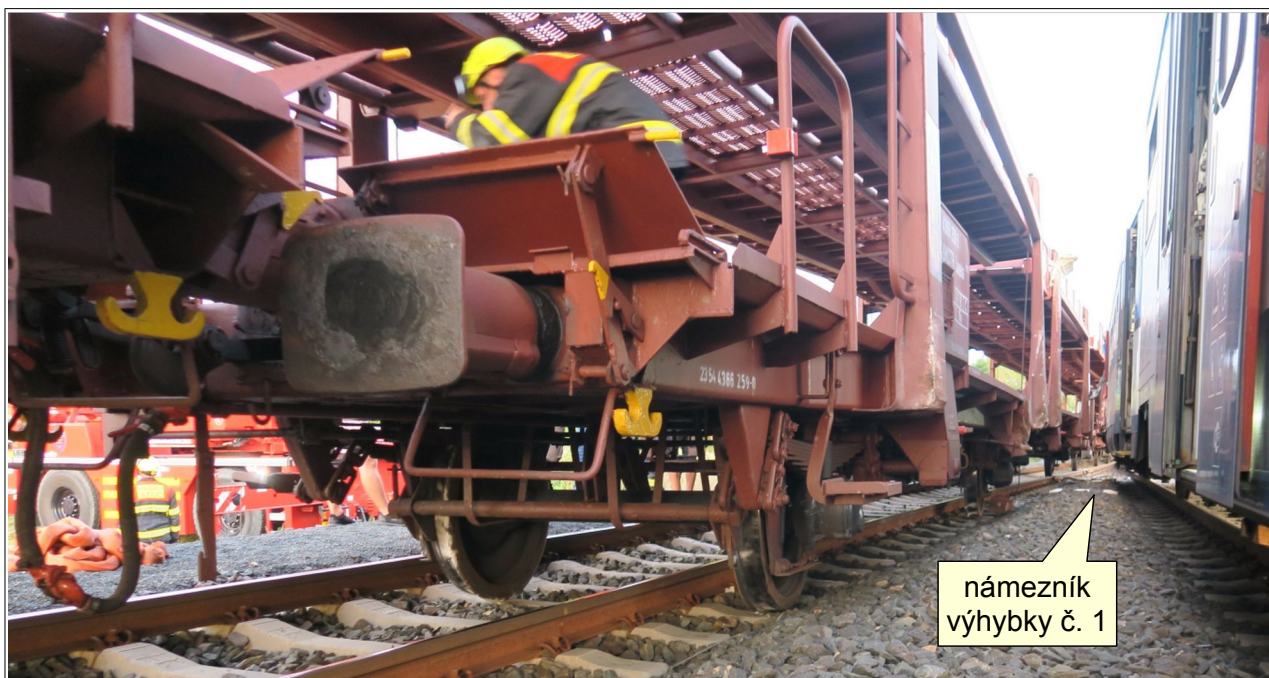
Obr. č. 3: Pohled na oběma nápravami vykolejený článek „A“ TDV 23 54 4366 259-0, s nárazníky zaklesnutými do před ním řazeného TDV 23 54 4366 136-0, v konečném postavení po vzniku MU
