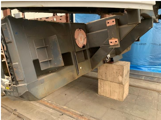
Figur 14: Innfesting av støtdempere på vogn 228 WGT-7. Bufferplaten er bøyd bakover i toppen. Foto: SHK
