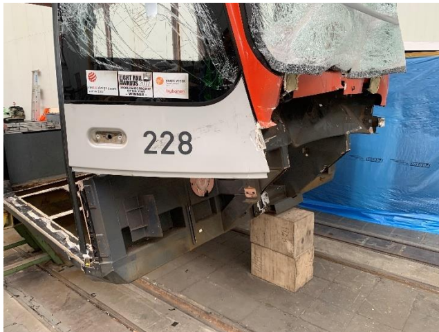
Figur 15: Skader i front av WGT-7. Treffpunktet er over støtdemperene. Foto: SHK
