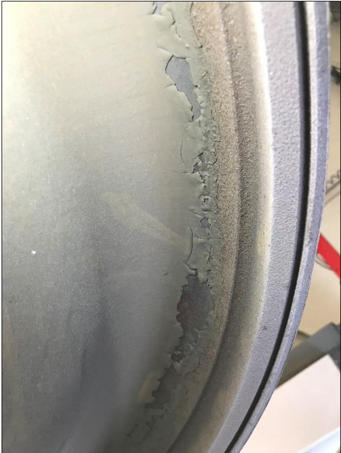
Foto 4. Malingsafskalning og korrosion i overgangen mellem hjulskive og hjulfælg.
