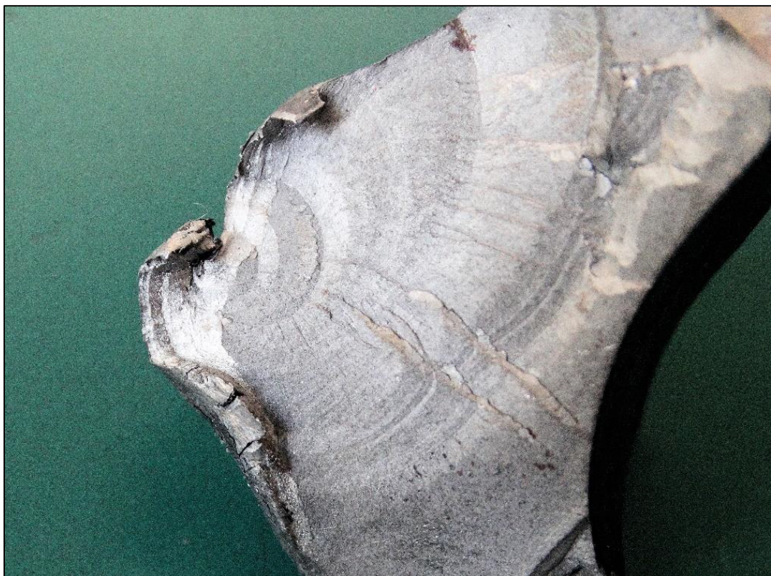
Foto 6. Initieringssted efter afrensning med Alconox®. Kilde: Force Technology.
