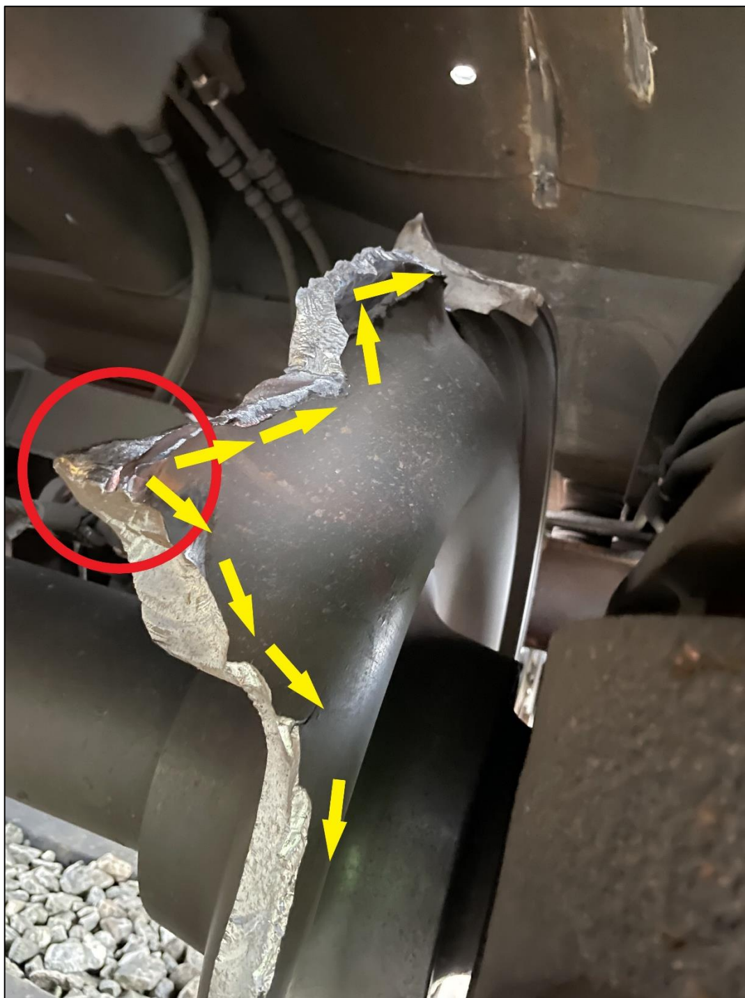
Figur 2. Initieringssted (startsted) og udbredelsesretning. Kilde: Force Technology.
