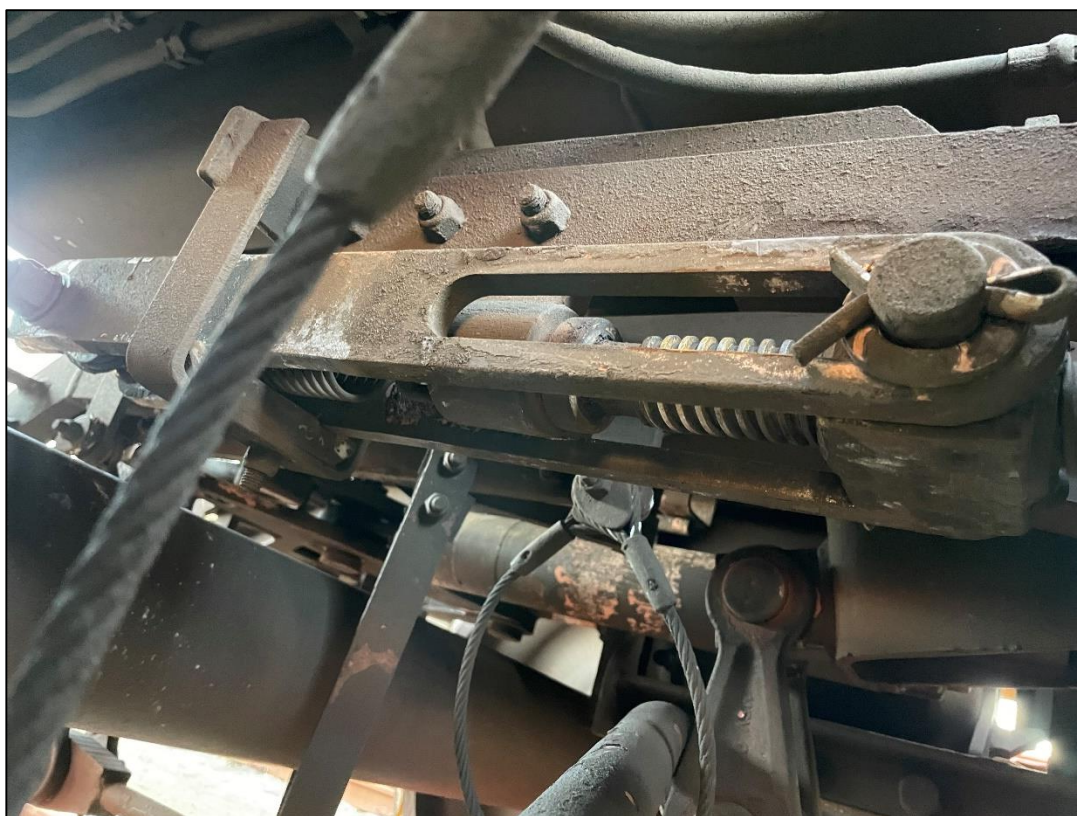
Foto 2. Skruebremseaktuator med gevindstang 8-9 omgange fra endestilling.
