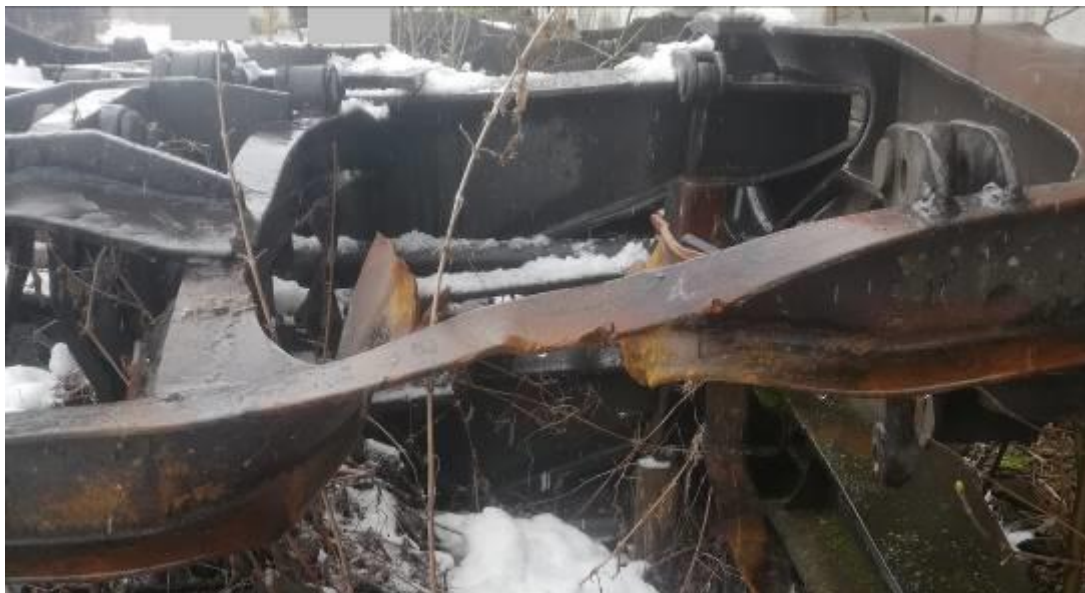
Foto nr.15 – cadrul de boghiu deformat
