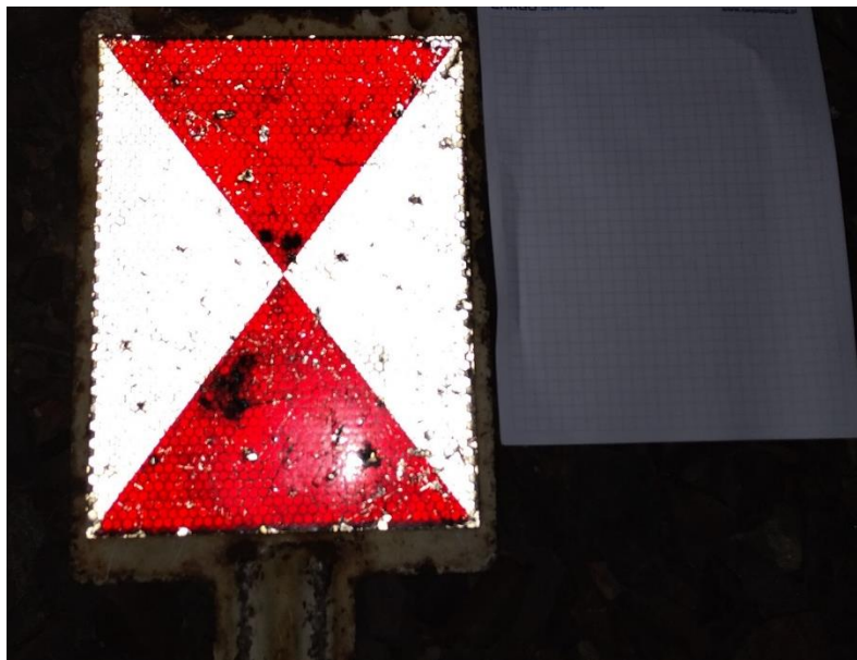
Zdjęcie 4. Tarcza sygnału końca pociągu zastosowana na pociągu TME 684013 (obok dla porównania biała kartka nie odbłaskowa)
