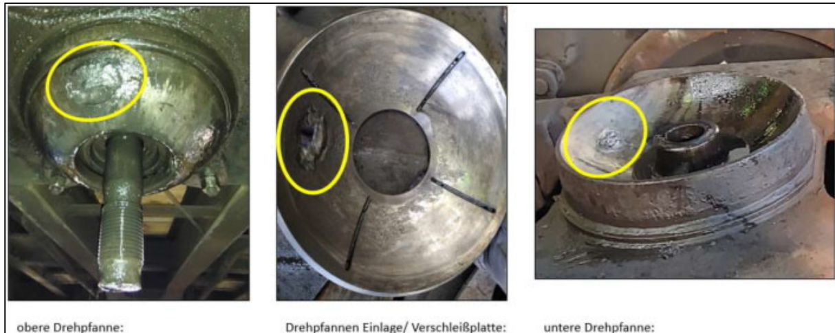
Abbildung 13: Verschweißstellen in den Drehpfannenkomponenten 7
