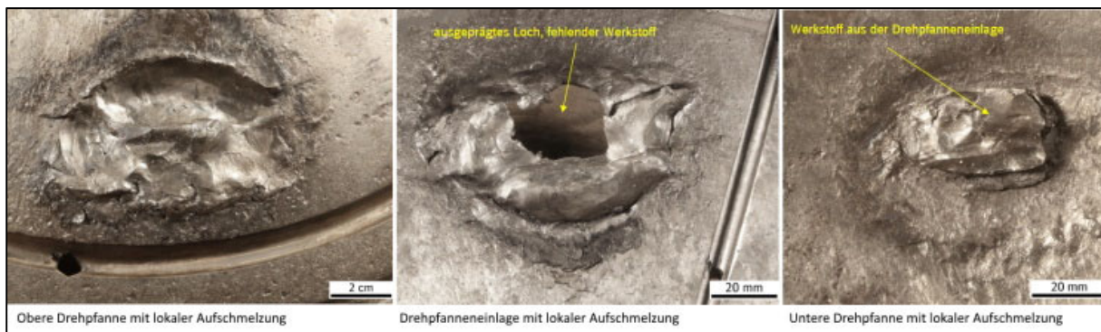
Abbildung 14: Materialveränderungen an den Drehpfannenkomponenten 8
