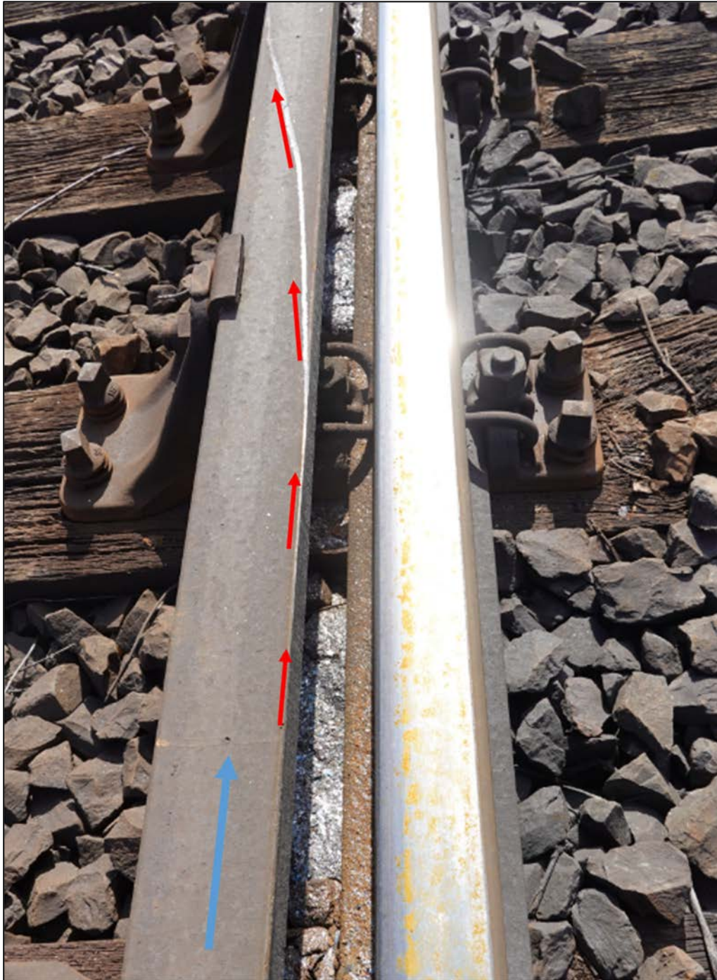
Abbildung 16: Detail der Entgleisungsspur am Radlenker im Abzweig der Weiche 12
