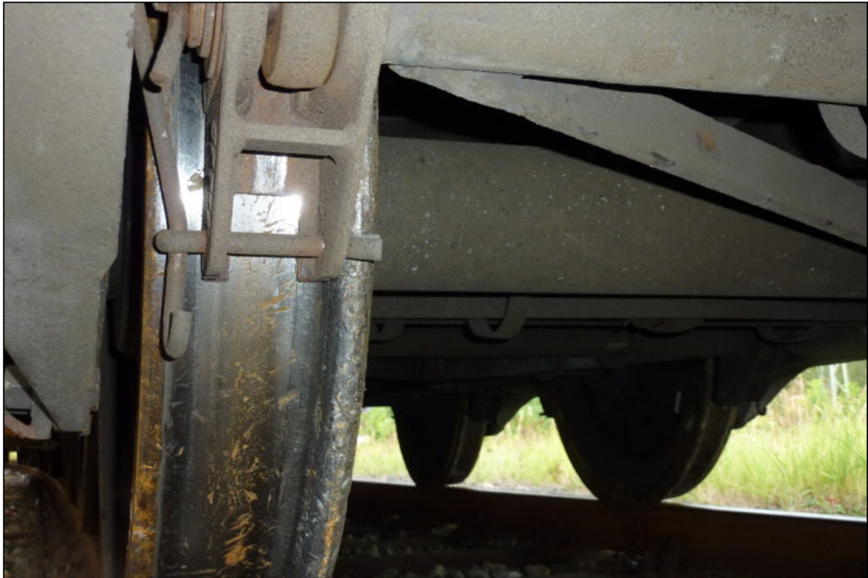
Abbildung 10: Lauffläche und Spurkranz mit Entgleisungsspuren Wagen 31 80 4871 375-0
