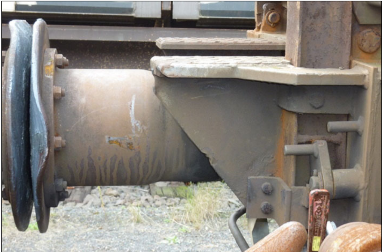
Abbildung 12: Beschädigter Puffer an Wagen 31 80 4871 375-0
