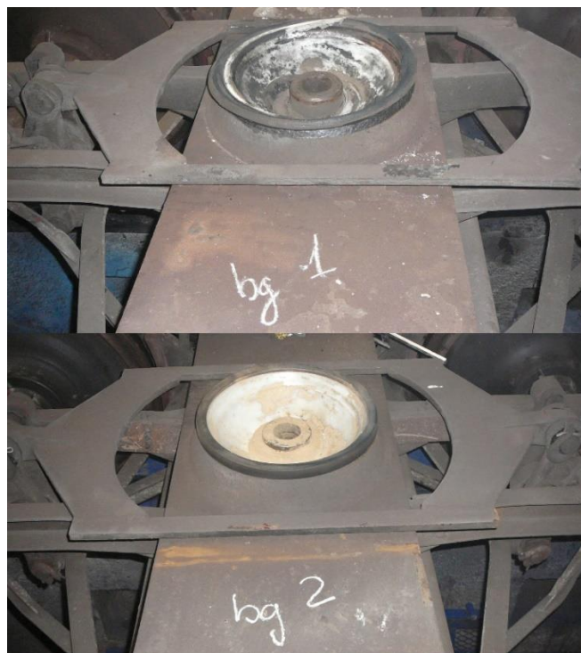
Fig. Nr.2, stare crapodina inferioară la boghiurile nr.1 și nr.2
