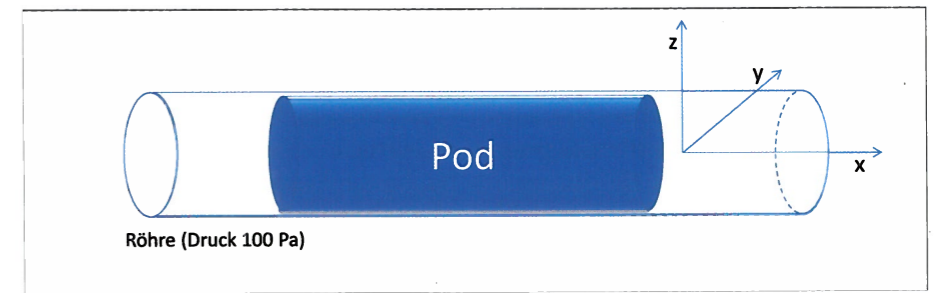
Bild 1: Prinzip von Hyperloop: ein Transportcontainer (Pod) bewegt sich im Fast-Vakuum in einer Röhre
