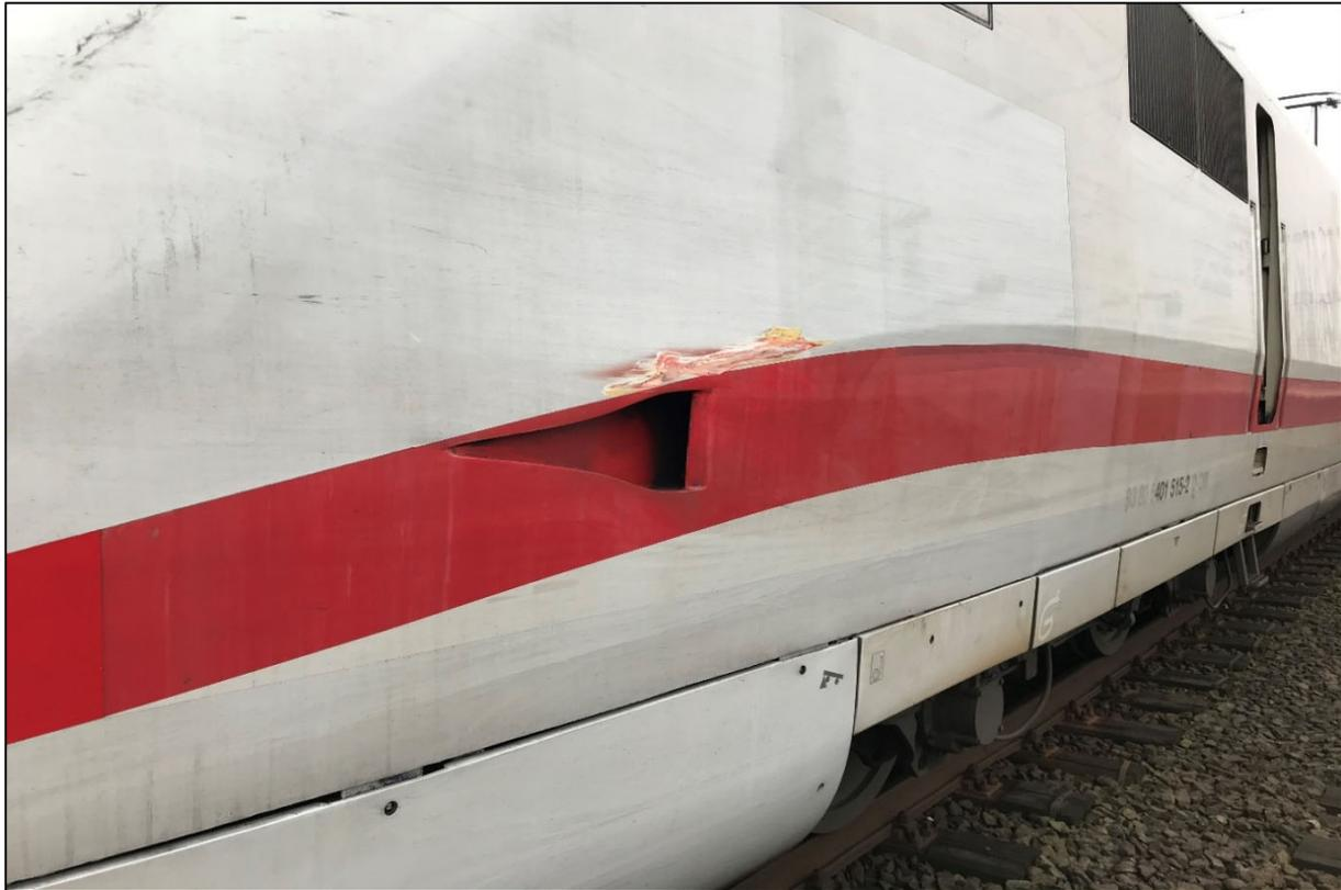
Abbildung 4: Schadbild an der Zugspitze des ehemaligen ICE-A 929<sup>4</sup>
