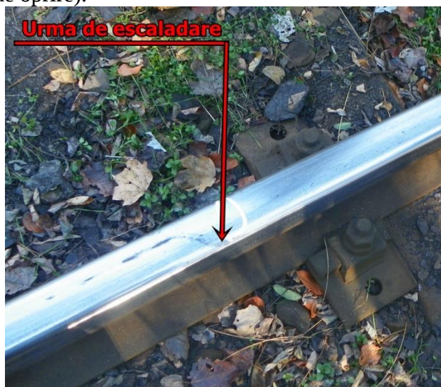
Foto nr.3: Punctul „0” - prima urmă de escaladare la km 19+608 (roata din partea dreaptă a osiei nr.6)
