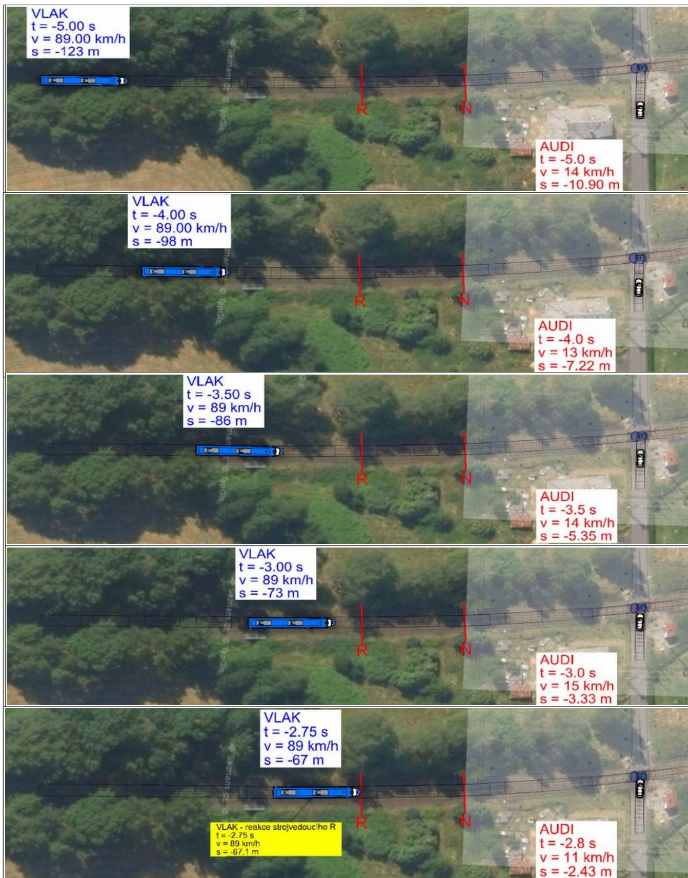
Obr. č. 19: Náhled simulace korelace (vzájemného) pohybu vlaku a 2. OA před střetnutím na ŽP P3277, kdy t = doba do srážky, v = rychlost vlaku/auta, s = zbývající vzdálenost do místa srážky Zdroj: Znalecký posudek
