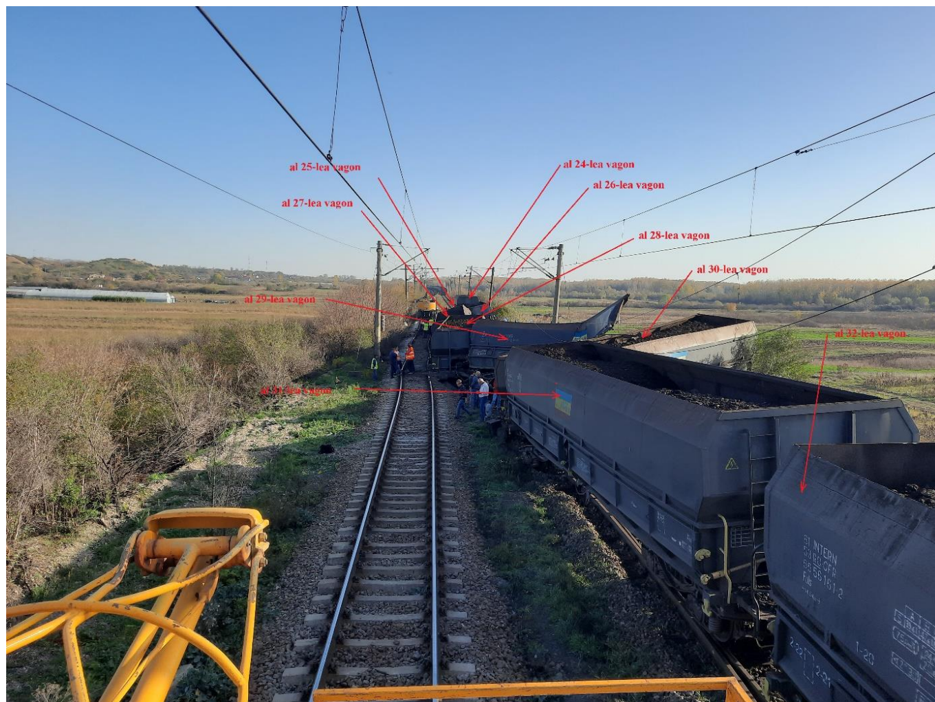
Foto nr.2 – poziția vagoanelor deraiate
