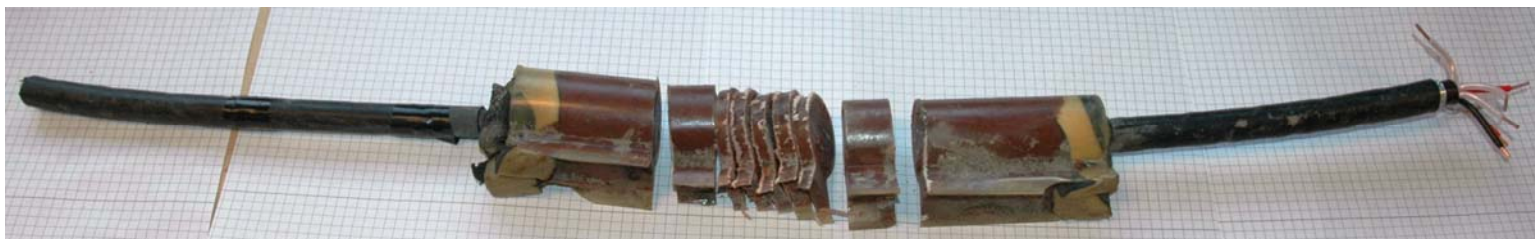
Figur 4 Oversiktsbilde av kabelskjøt etter seksjonering.
