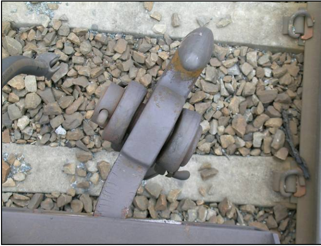
Figur 5: Koblingskroken ble bøyd på den siste vognen som stanset i spor 1.
