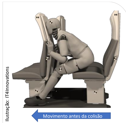
Figura 78: Ilustração da colisão secundária do corpo de um passageiro sentado, imediatamente após uma colisão
