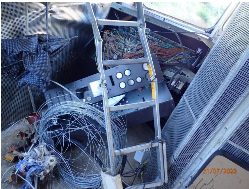
Figura 91: Imagem do posto de trabalho da tripulação, no local do acidente, evidenciando que o espaço de sobrevivência não foi comprometido pela deformação estrutural da cabina, mas que o mesmo foi invadido por equipamentos e materiais a bordo
