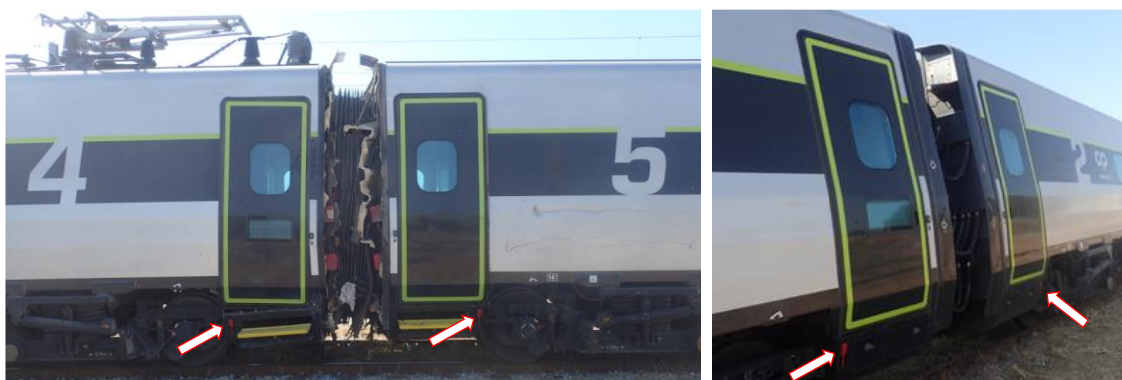
Figura 93: Portas para o exterior/interior do CPA, assinalando os pequenos manípulos de comando da abertura de emergência
