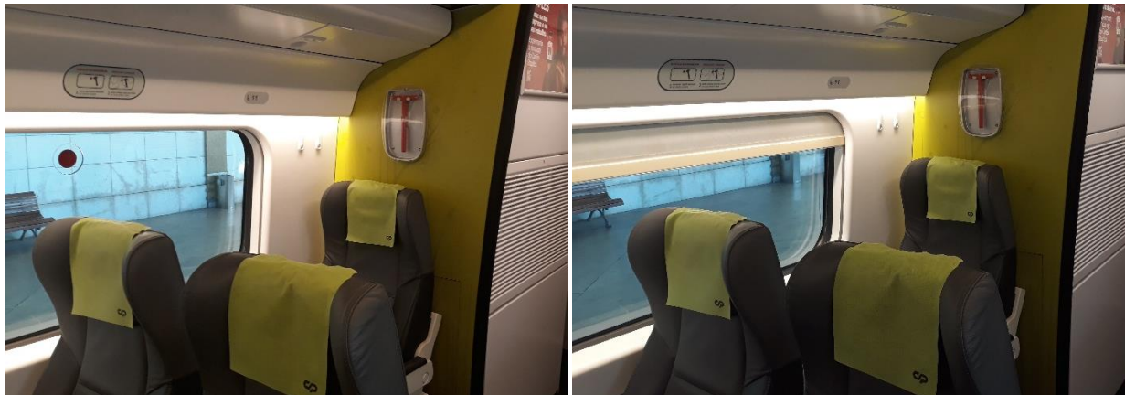
Figura 86: Vista interior de um vidro de emergência numa carruagem de CPA, mostrando a situação com a janela totalmente descoberta (à esquerda) e com o quebra-luz ligeiramente descido (à direita)
