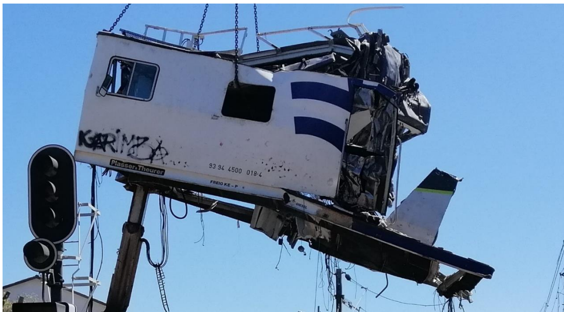
Figura 89: Imagem da cabina do VCC 105 sendo removida do local do acidente, ilustrando bem a sua fácil separação do leito, bem como a forte deformação sofrida pela colisão do CPA 4005
