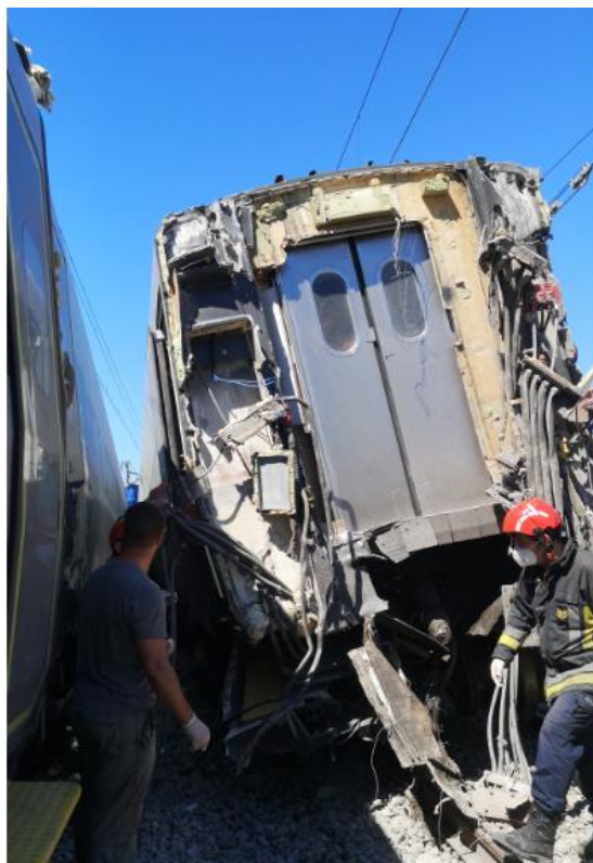
Figura 31: Imagem da cabeceira com as portas de intercomunicação da carruagem 6 (BAN)
