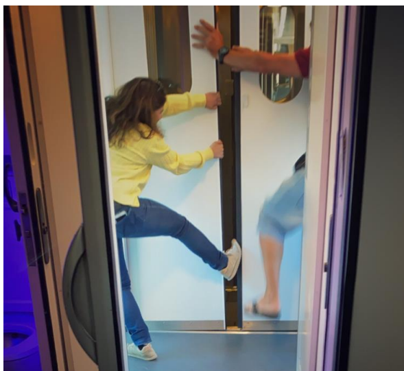
Figura 30: Tentativa para a abertura das portas de intercomunicação entre as carruagens [ @SIC ]
