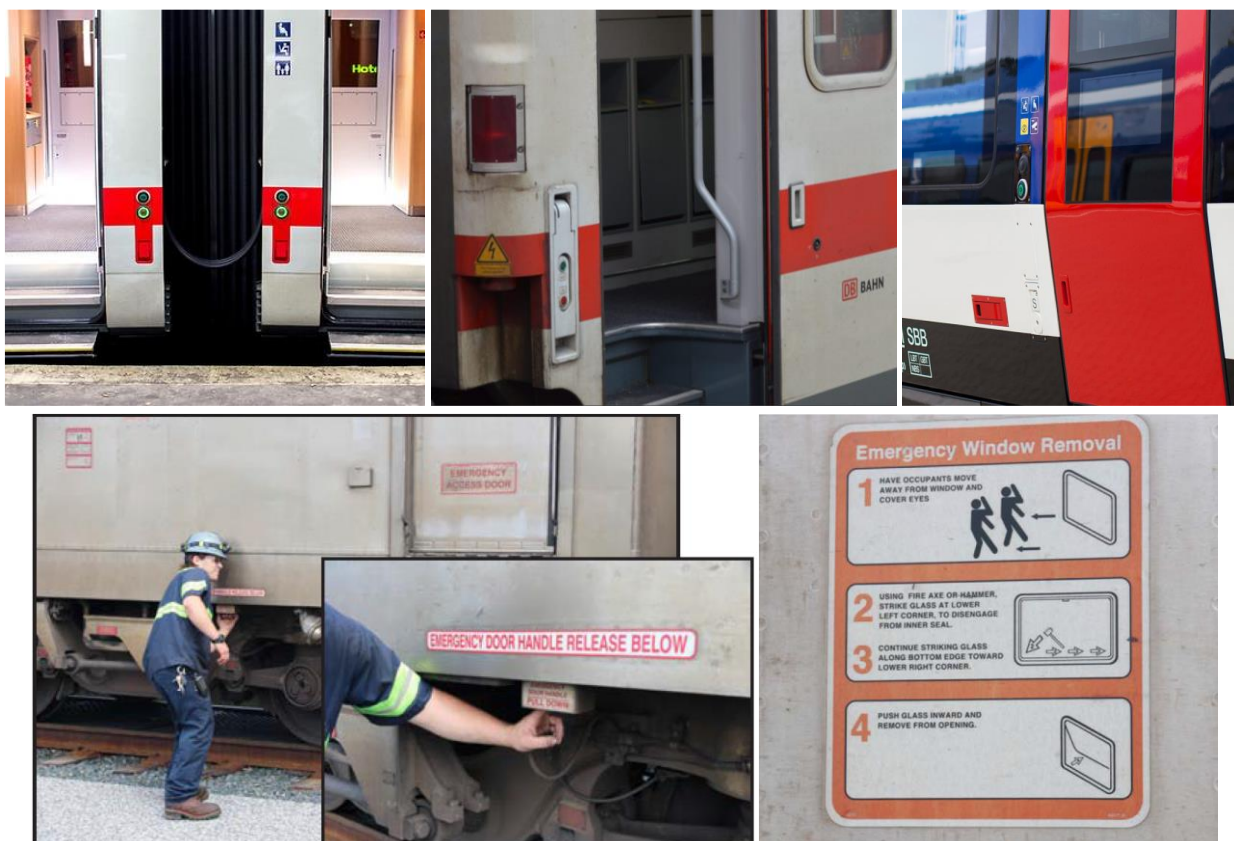
Figura 94: Exemplos de identificação de acesso de emergência (Alemanha, Suíça, Estados Unidos)
