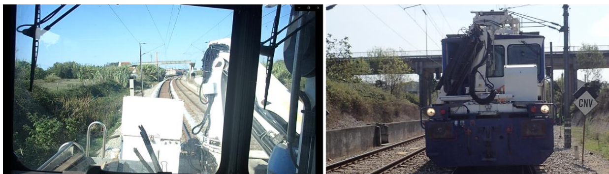
Figura 41: Ângulo de visão em plena via desde a posição do maquinista (esq.) e aspeto visto do exterior (dir.)
