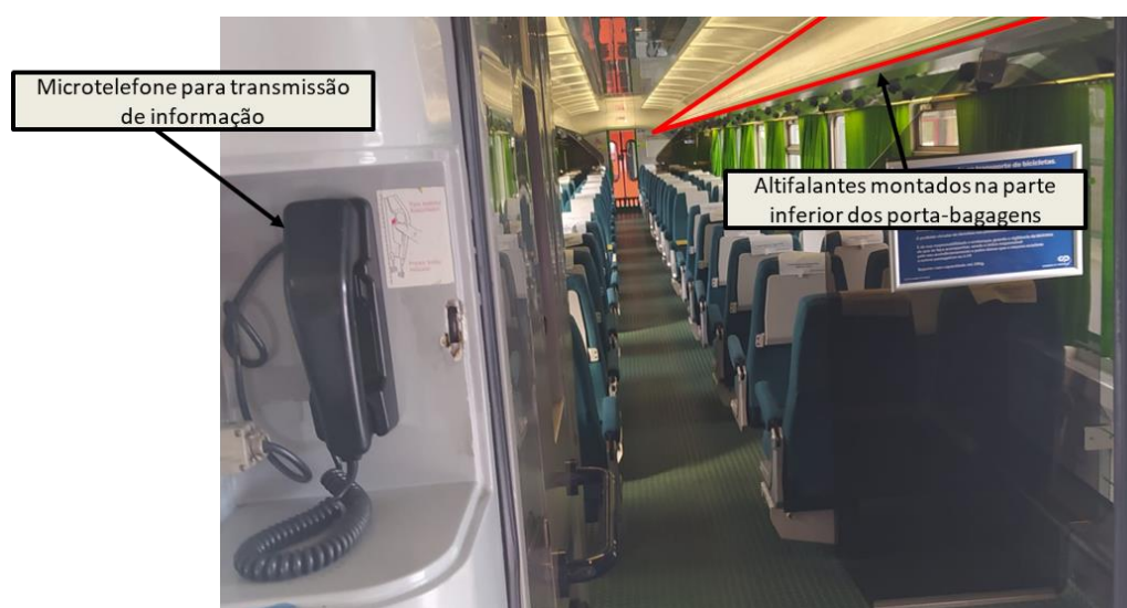
Figura 15: Exemplo de localização do microtelefone e altifalantes (carruagem Sorefame modernizada)
