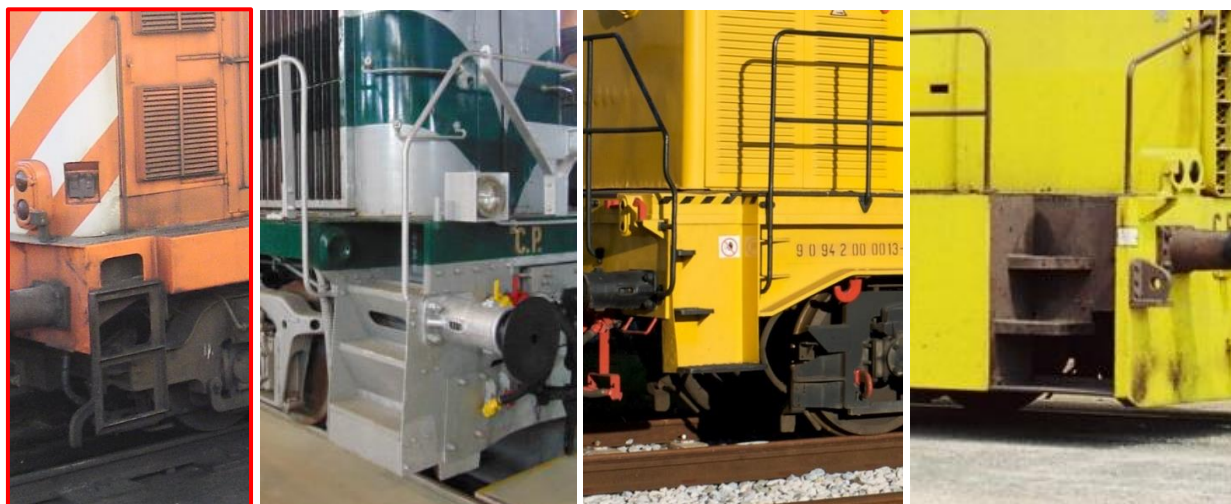
Figura 20: Degraus e corrimãos para manobrador das locomotivas da série 1400 (à esquerda), comparados com locomotivas de outras séries já retiradas de serviço
