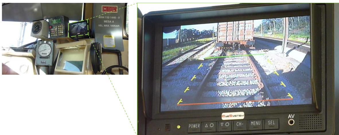
Figura 33: Sistema experimental de televisualização instalado na locomotiva MEDWAY 1446 para apoio ao maquinista na realização de manobras
