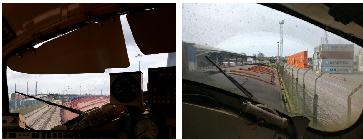
Figura 17: Visibilidade do maquinista de uma locomotiva série 1400 desde o posto de condução n.º 1 (imagem à esquerda) e desde o posto de condução n.º 2 em situação de recuo (imagem à direita)
