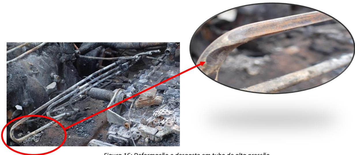
Figura 16: Deformação e desgaste em tubo de alta pressão
