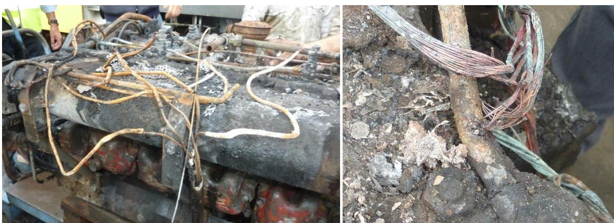
*Figura 13: Cablagem elétrica destruída pelo incêndio*
