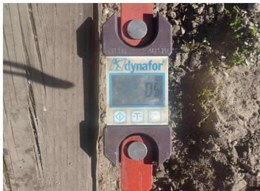
Figura 45: Dinamómetro intercalado na vara de comando de um AMV manual com aferrolhamento de esquadro
