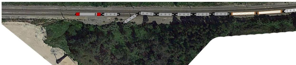
Figura 54: Ilustração da posição do comboio e do vagão descarrilado após embate deste no poste de catenária
