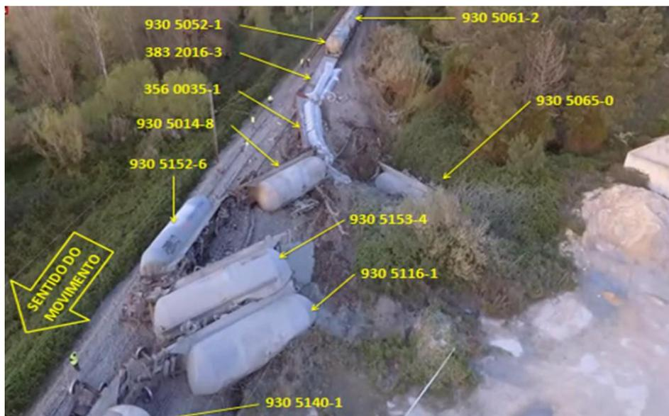
Figura 2: Identificação dos vagões descarrilados
