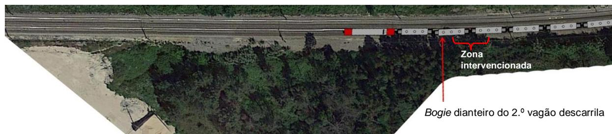
Figura 45: Ilustração da posição do comboio no momento de início do descarrilamento.
