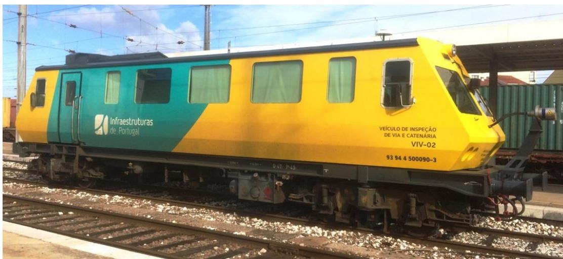
Figura 28: Veículo de inspeção de via e catenária VIV 02 (EM-120) do GI [imagem IP]
