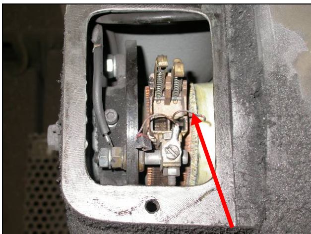
Figur 15: Bilde av viftemotor med manglende børster.
