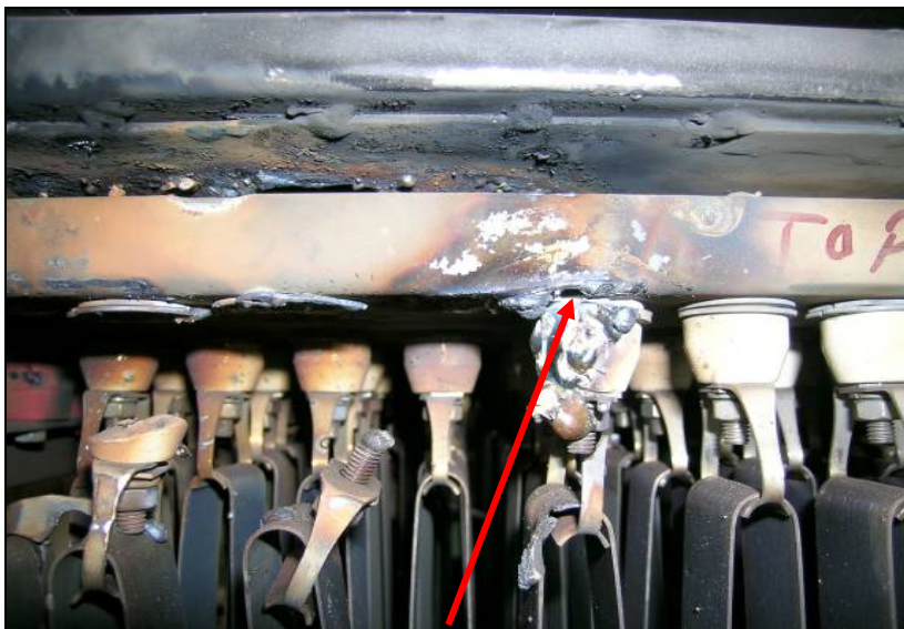
Figur 11: Bilde av kjørebremsekontakt etter lysbue.
