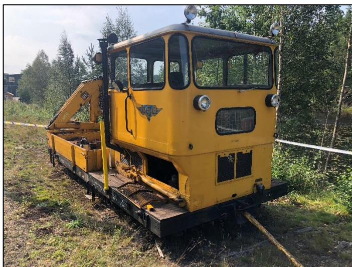
Figur 4: Robel arbeidsmaskin litra 30-36-3007. Foto: SHT
