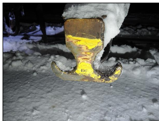
Figur 10: Skrapemerker på nedbindingskrok. Foto: SHT
