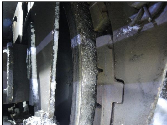
Figur 7: Skader på hjulbane vogn 3. Foto: SHT
