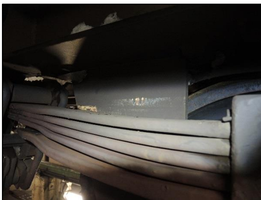
Figur 11: Skrapemerker viser kontakt mellom fjær og vognramme. Foto: SHT
