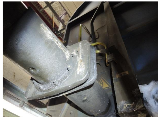
Figur 12: Skrapermerker på buffer etter ombufring. Foto: SHT
