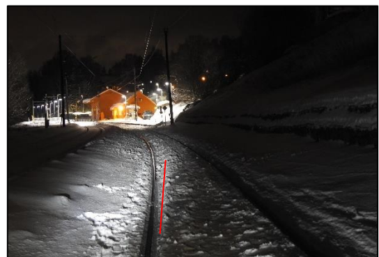
Figur 16: Spor fra venstre hjul bakre aksling vogn 3. Foto: SHT
