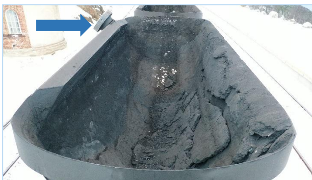
Figur 16: Lastrester i avsporet vogn 87 74 6845027-6. Fotoet er tatt motsatt av togets kjøreretning. Pilen peker på hjulet som benyttes ved tømning av vogn. Foto: SHK
