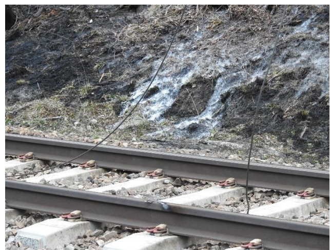
Figur 12: Hengende bæreline. Foto: SHK
