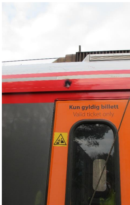
Figur 8: Svimerke i vognkasse. Foto: SHK
