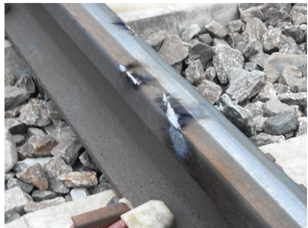
Figur 4: Merker etter bærelina mot skinne. Foto: SHK
