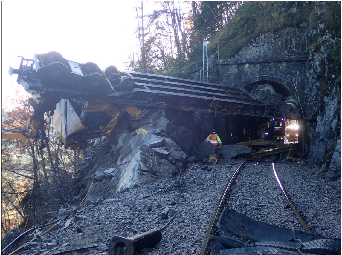
Figur 3: Pukksugeren etter avsporingen. Foto: SHT
