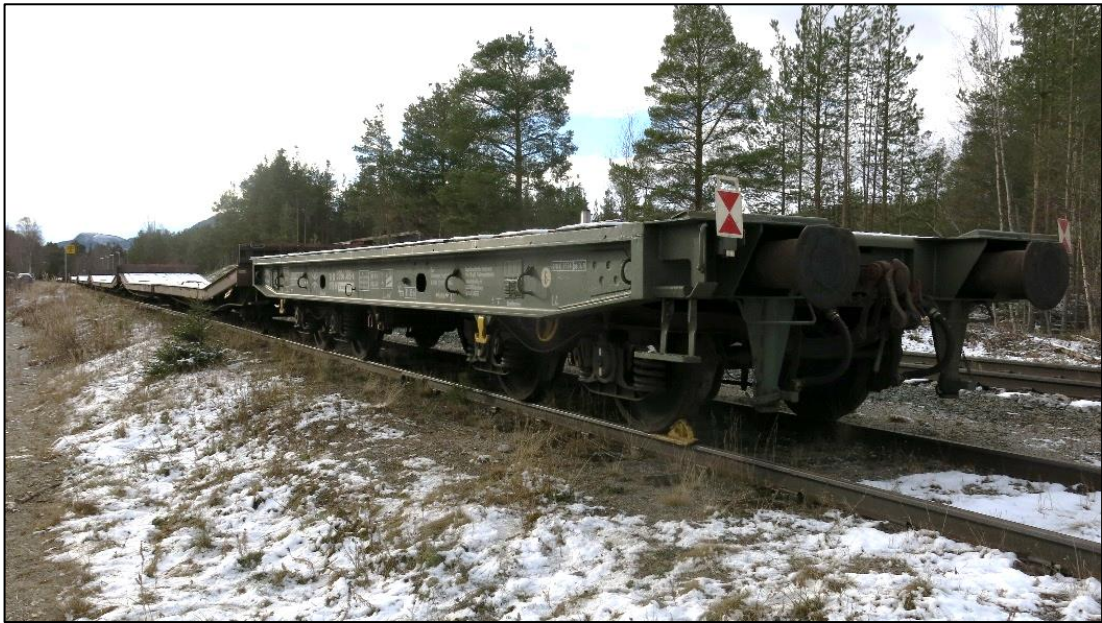
Figur 7: Vognstammen som rullet over sporsperren. Foto: SHT
