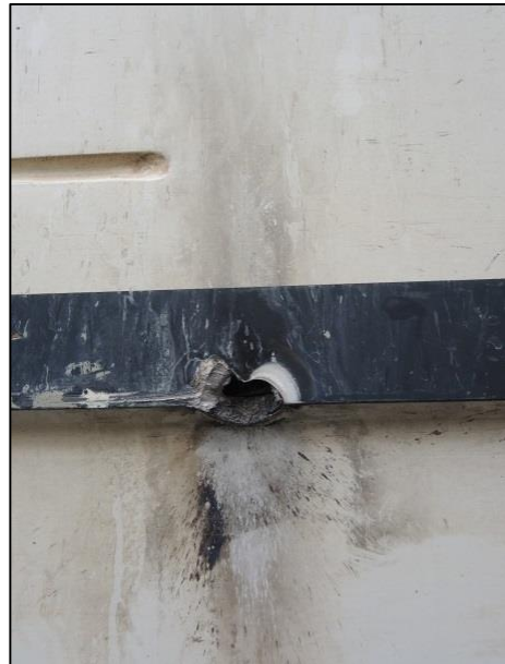
Figur 7: Merker etter overslag på vogn 3334. Foto: SHT
