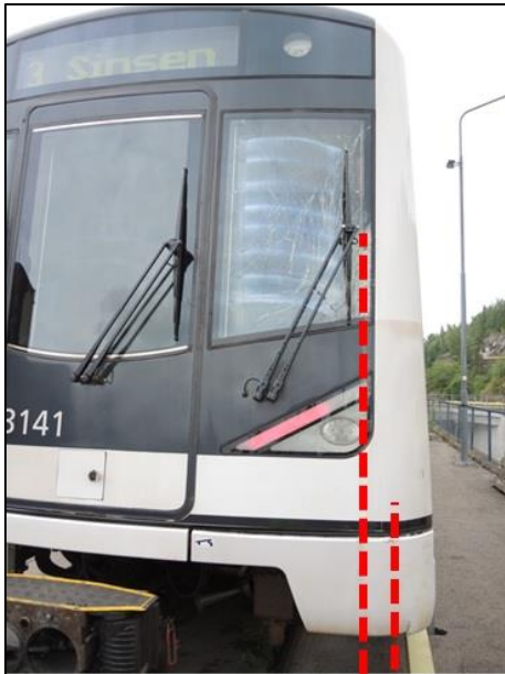
Figur 6: Skader i front etter borstenger. Foto: SHT
