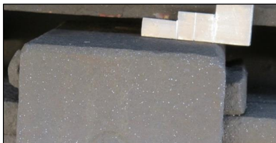
Figur 32: Vogn 138-5 målt under 10 mm (Gävle 21. mai 2014). Foto: SHT
