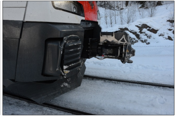
Figur 4: Skader i fronten på toget. Foto: SHT Figur 5: Inntrykket buffer. Foto: SHT
