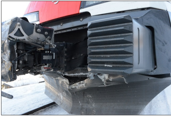
Figur 4: Skader i fronten på toget. Foto: SHT Figur 5: Inntrykket buffer. Foto: SHT
