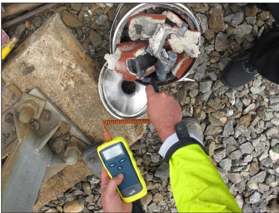
Kl. 1411: Thermit-restene holder fortsatt 300 °C. Foto: Gnister sprutet 1,5 meter. Foto: SHT
