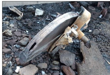
Figur 40: Gnistfanger på utstyr til skinneskapping. Foto: Vitne
