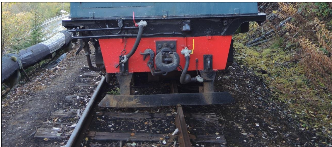
Figur 5: Skadet avspøringsvern. Foto: SHT
