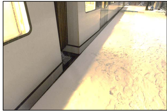
Figur 7: Sammenkobling mellom vognene. Foto: SHT
