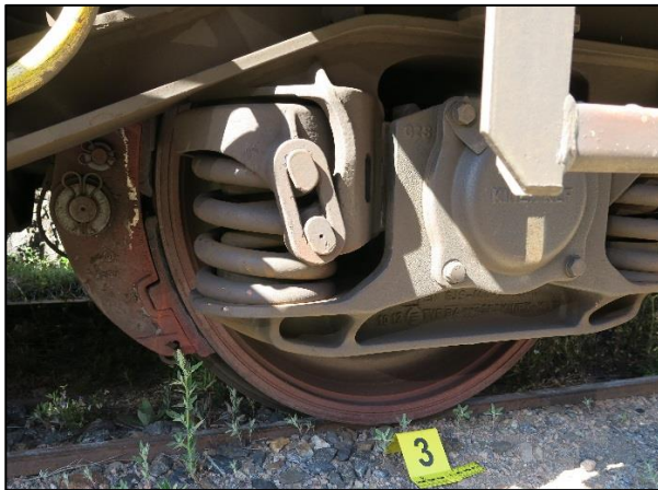
Figur 6: Slitte bremsklosser. Foto: SHT
