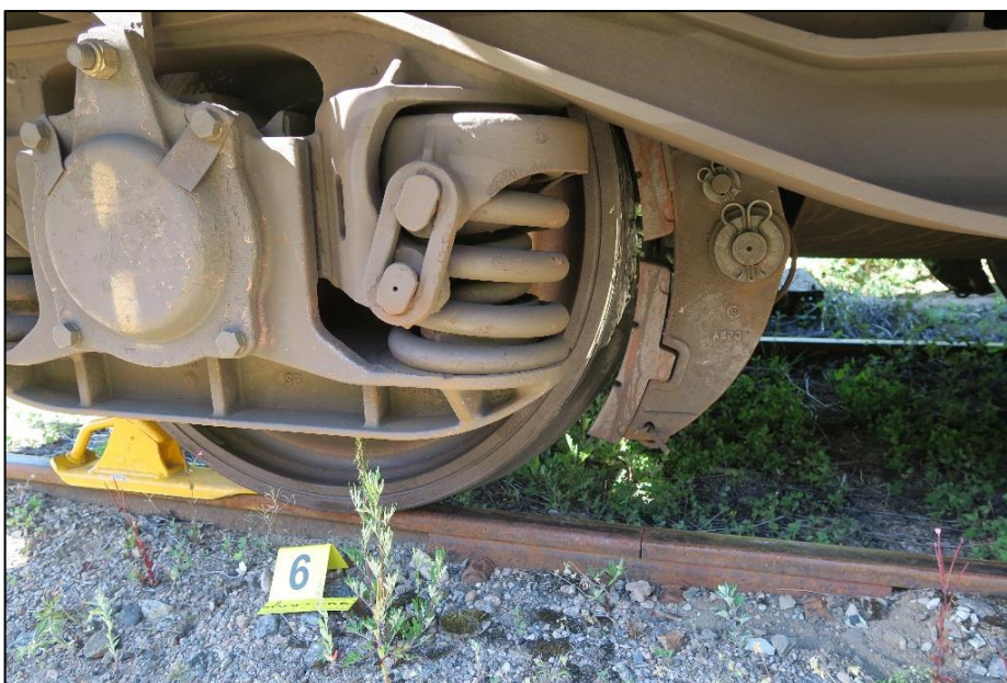
Figur 3: Et av hjulene som hadde tjuvbremser. Foto: SHT
