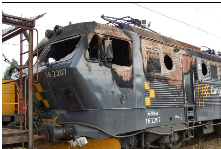
Figur 4 Lokomotiv El 16.2207 som brant i Sverige ble helt utbrent innvendig, og fikk omfattende skader utvendig.
