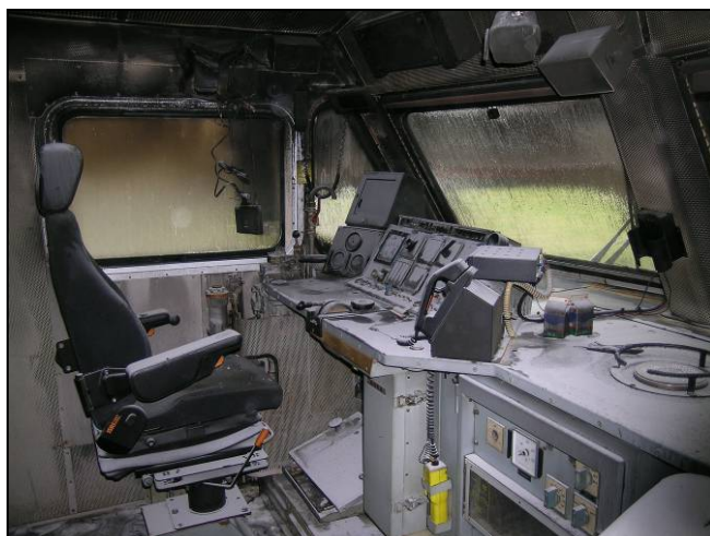
Figur 3 Brannskader i det ene førerrommet til lokomotiv 16.2216.
