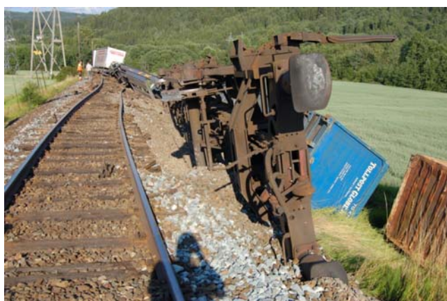
Figur 1: Avsporede og veltede vogner sett bakover i toget.
