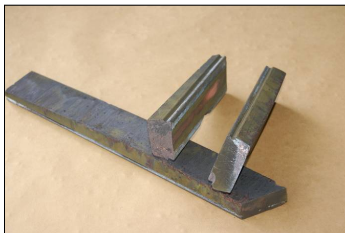
Figur 5: Avrevne biter fra grafittskinne på strømvogteren til tog 103, type T-2000.
