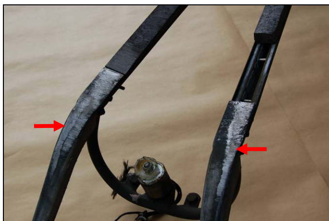
Figur 4: Slitasjemerker på den defekte strømvogteren på tog 103, type T-2000.
