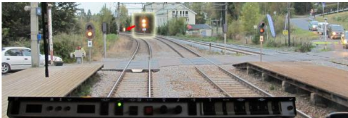
Figur 6: Togsporsignalet viser to hvite faste lys. Tog i spor 1 kan kjøre med redusert hastighet. (Kilde: SHT)
