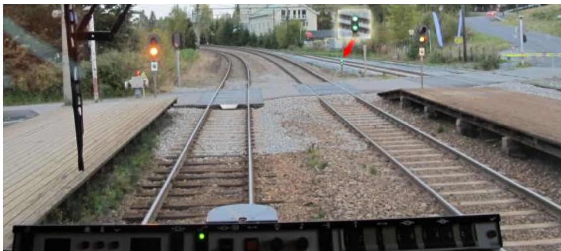
Figur 5: Togsporsignalet viser to grønne faste lys. Tog i spor 2 kan passere stasjonen med største tillatte hastighet. (Kilde: SHT)
