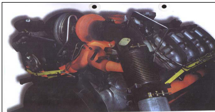
Figur 13: Viser hvor varmt eksosrør kan bli. Ved rød farge vil det være ca. 600 – 800° C og rød/ brun farge = ca. 550° C. Gul farge vil si at det er ca. 1000° C. Kilde: IF Skadeforsikring.
