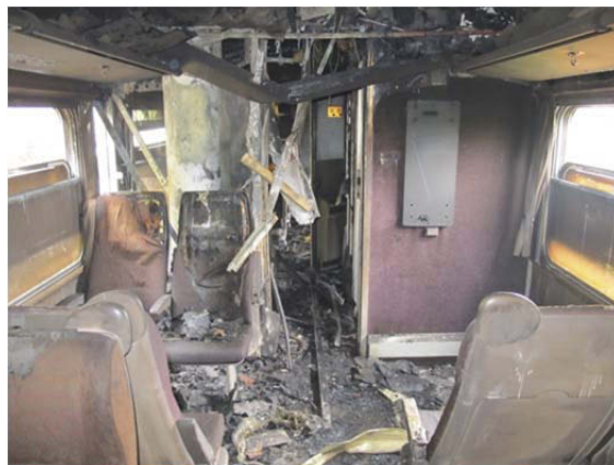
Figur 6: Brannskader på inventaret.
