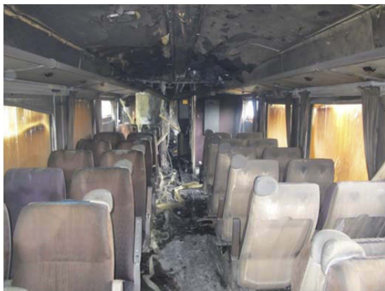
Figur 5: Brannskader i taket.
