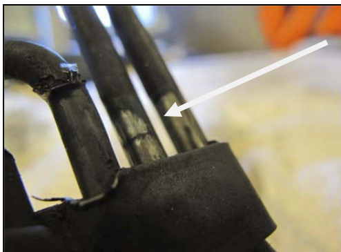
Figur 7: Slitasje på dieselryr fra ulykkestoget.
