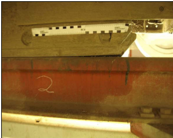
Figur 7: Viser magnetskinnebrems, buet og med slitt glideflate.
