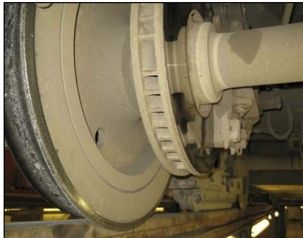
Figur 8: Viser sort belegg på hjulbane. Skivebremsene er blanke og i orden.
