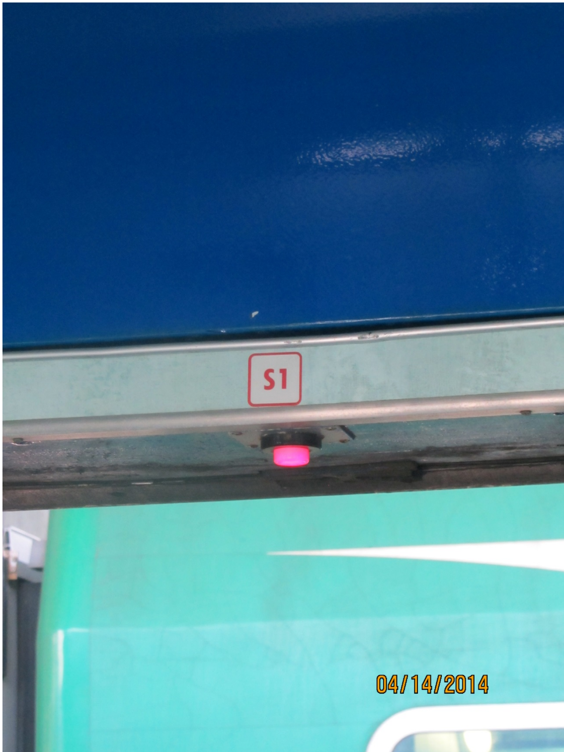
Figura 6 - Foto porta lato interno - particolare della lampada segnalante porta aperta
