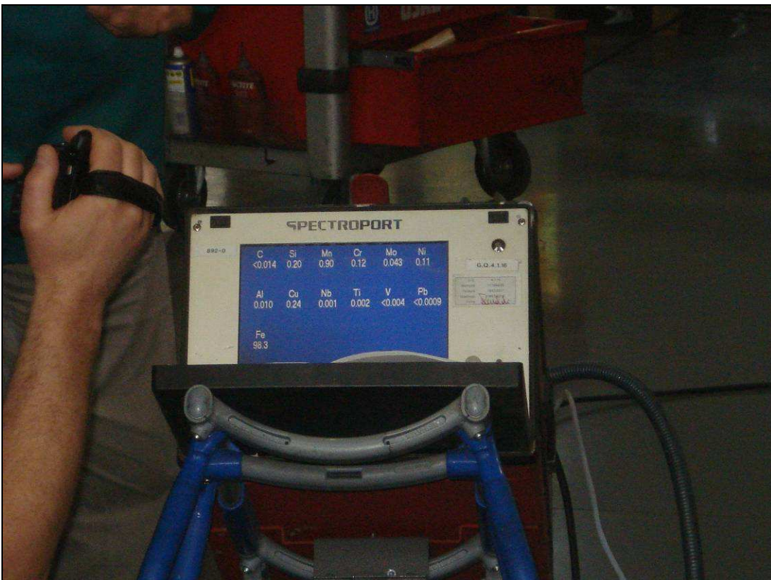
Quantometro portatile con i risultati della prova numero due – fonte Commissione Ministeriale di Indagine
