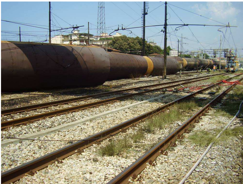
Secondo terzo e quarto carro cisterna ribaltati vista lato Via Ponchielli – Fonte Commissione Ministeriale di Indagine
