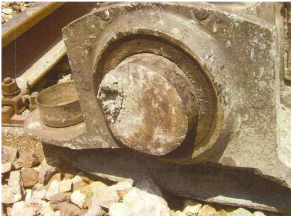
Supporto della boccola e boccola con visibile il fusello dell'assile 98331 tranciato - Fonte Commissione Ministeriale di Indagine
