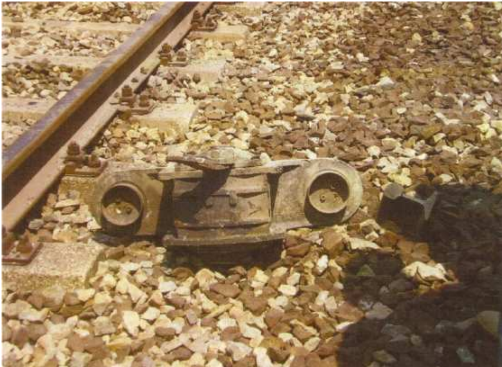
Supporto della boccola e boccola - Fonte Commissione Ministeriale di Indagine
