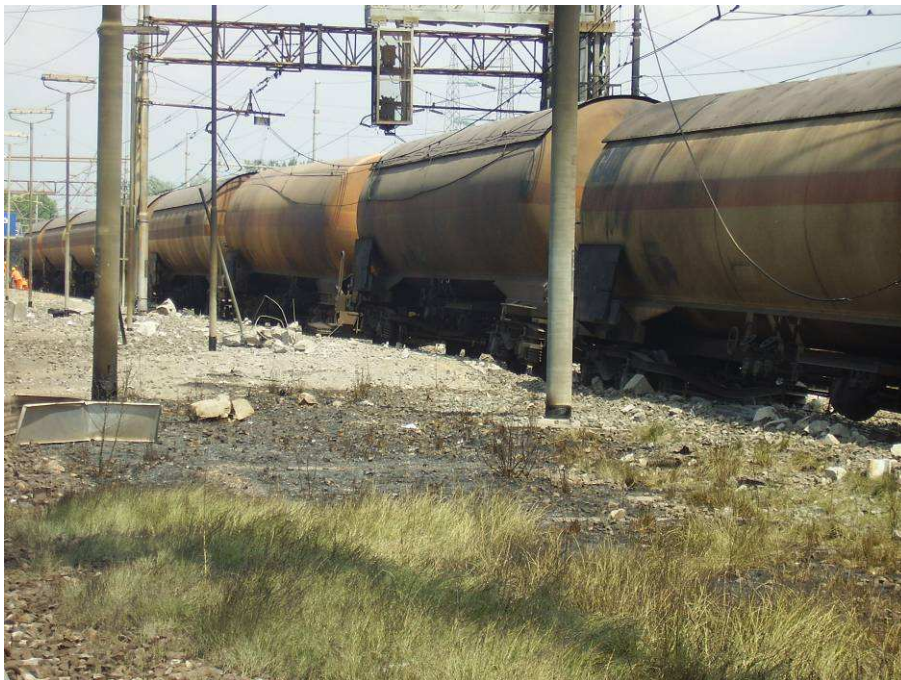
Carri cisterna sesto e settimo carro cisterna sviati – Fonte Commissione Ministeriale di Indagine
