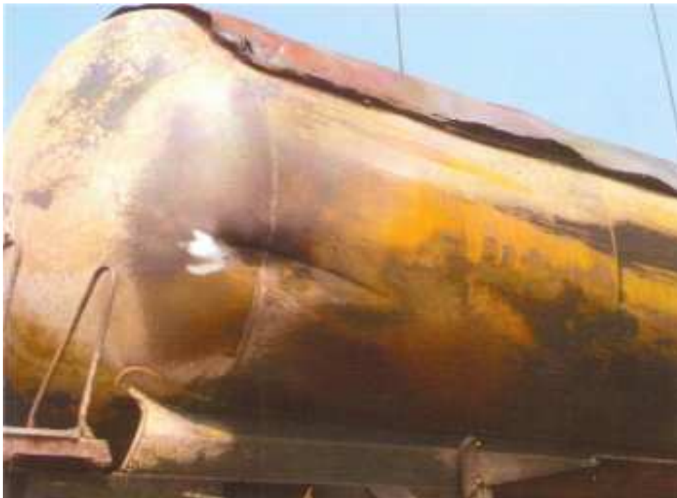
Particolare dello squarcio sulla cisterna del primo carro - fonte Commissione Ministeriale di Indagine
