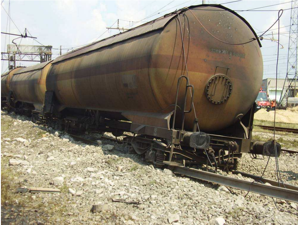
Particolare carri cisterna sesto e settimo carro cisterna sviati – Fonte Commissione Ministeriale di Indagine
