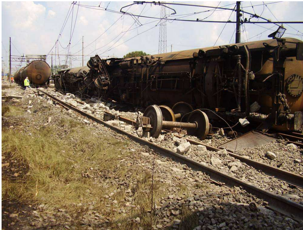
Terzo e quarto carro cisterna ribaltati - Fonte Commissione Ministeriale di Indagine
