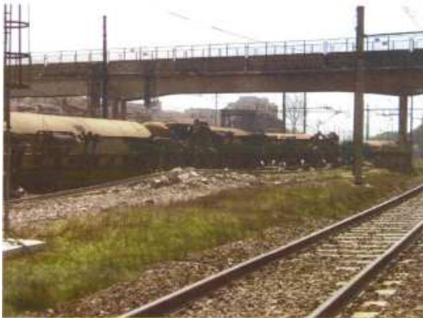
Assieme dei primi quattro carri cisterna ribaltati – Fonte Commissione Ministeriale di Indagine
