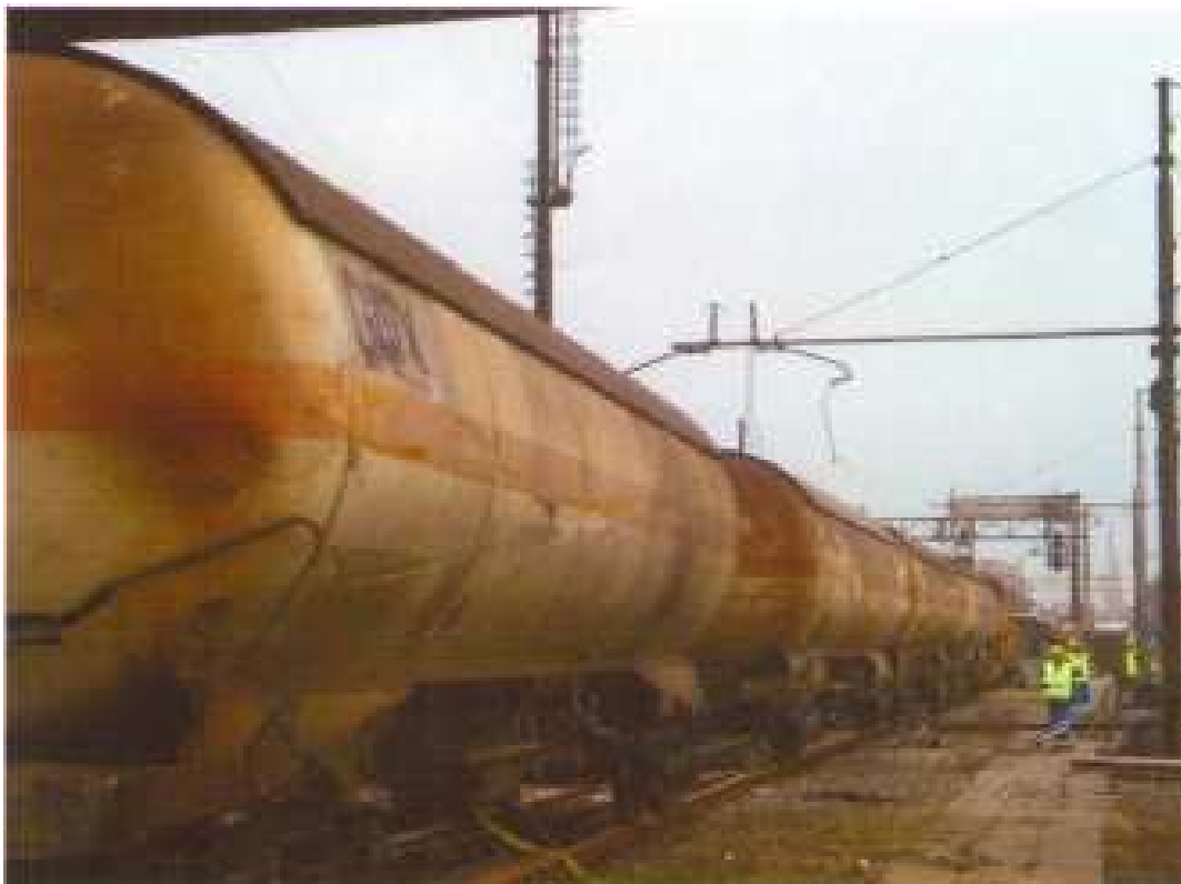
Carri sviati recuperati e con nuovi carrelli applicati – Fonte Commissione Ministeriale di Indagine (foto 24)
