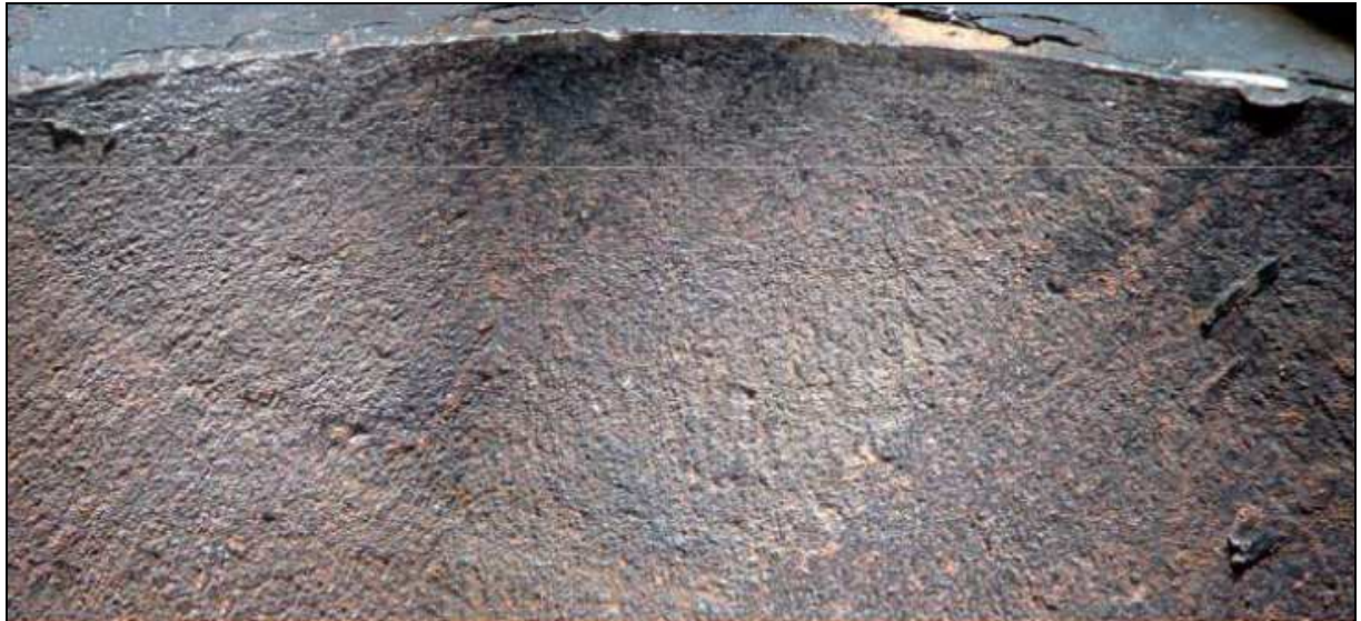
ingrandimento zona dell'innescò (fonte report Lucchini)
