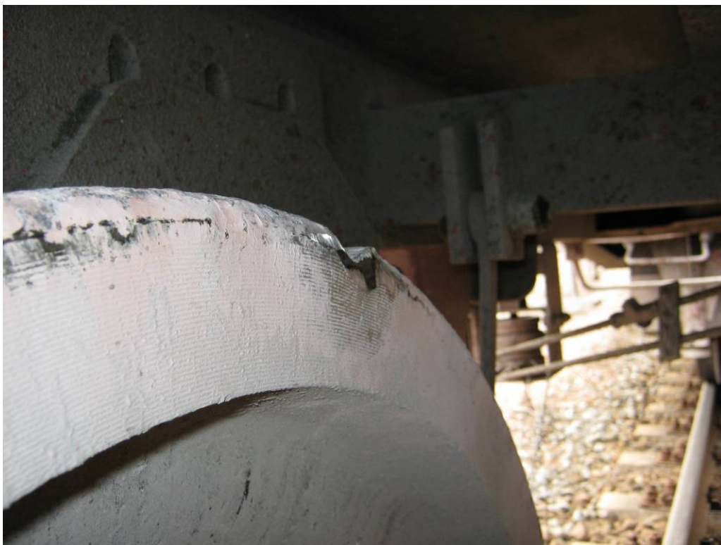
Abb. 21: Kerbe im Spurkranz des linken Rades im vorderen Radsatz des entgleisten Wagens
