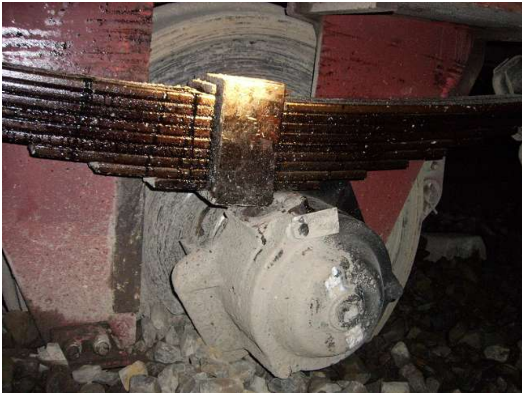
Abb. 22: Das Radsatzlager des Radsatzes 2 wurde verdreht und ohne Distanzringe aufgefunden
