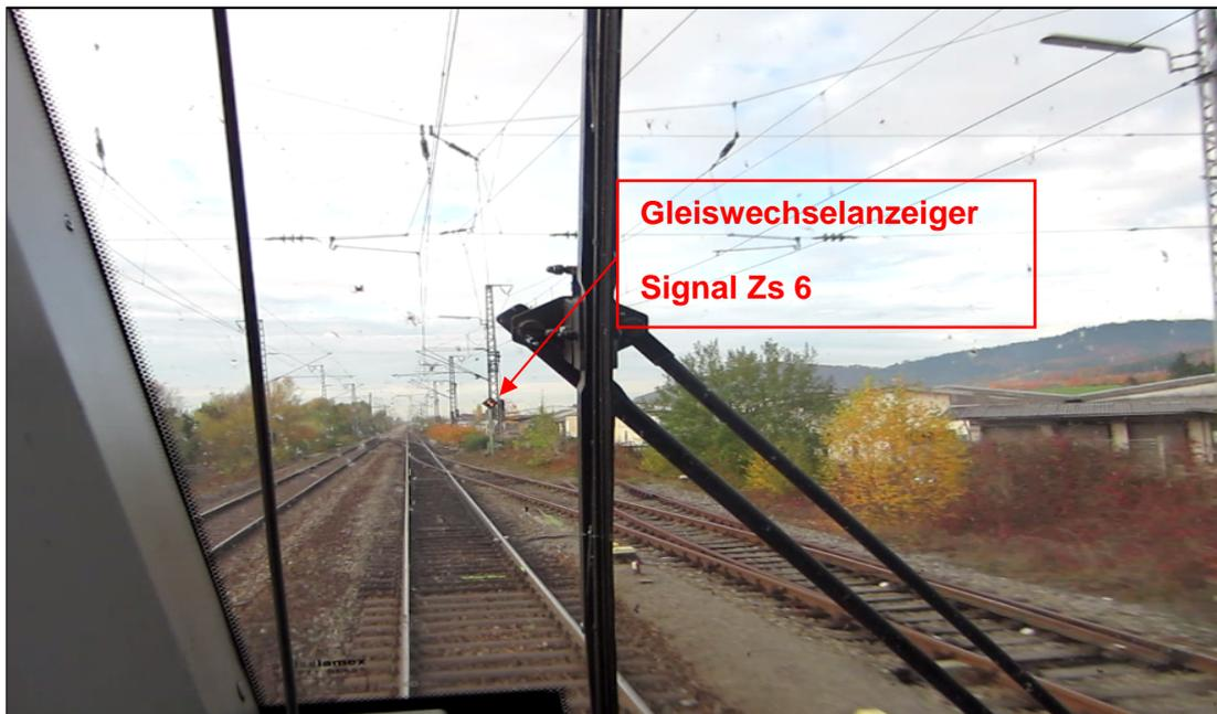
Abb. 5: Signal Zs 6, Gleiswechselanzeiger
