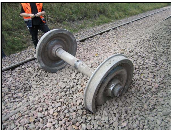
Abb.: 8 fehlender Achsschenkel und Radsatzlager
