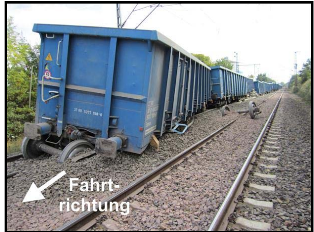
Abb.: 5 Entgleisung von 11 beladenen Enos-Wagen
