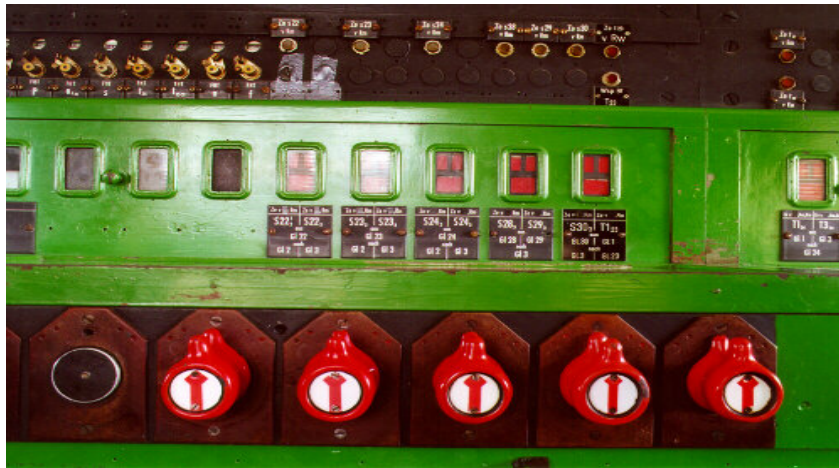
Detailansicht einiger Fahrstraßensignalhebel der Bauart E 43
