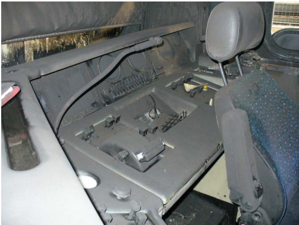
Abb. 9 Führerstand 2 - Schäden durch Rauch- und Rußablagerungen
