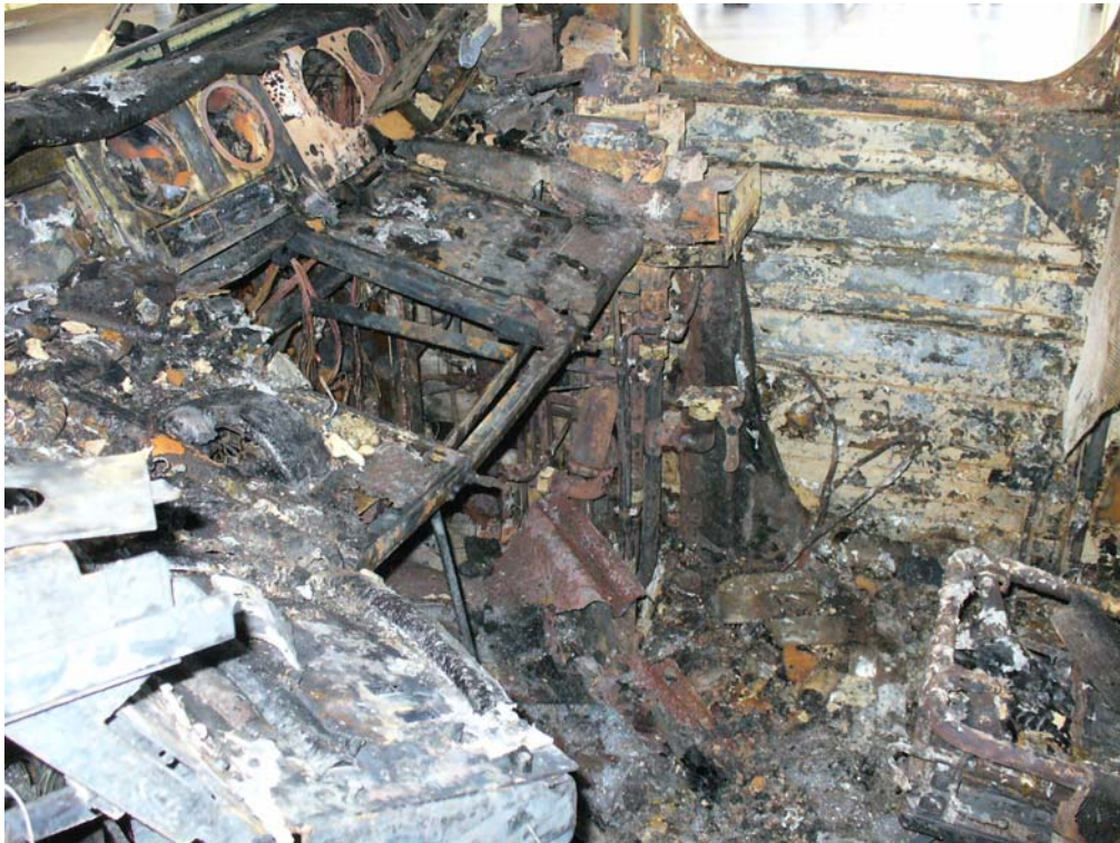
Abb. 8 Brandschäden im Inneren des Tfz - Führerstand 1
