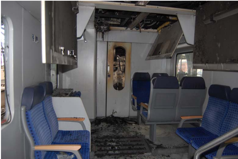
Abb. 11 Schäden im Inneren des Doppelstockwagens
