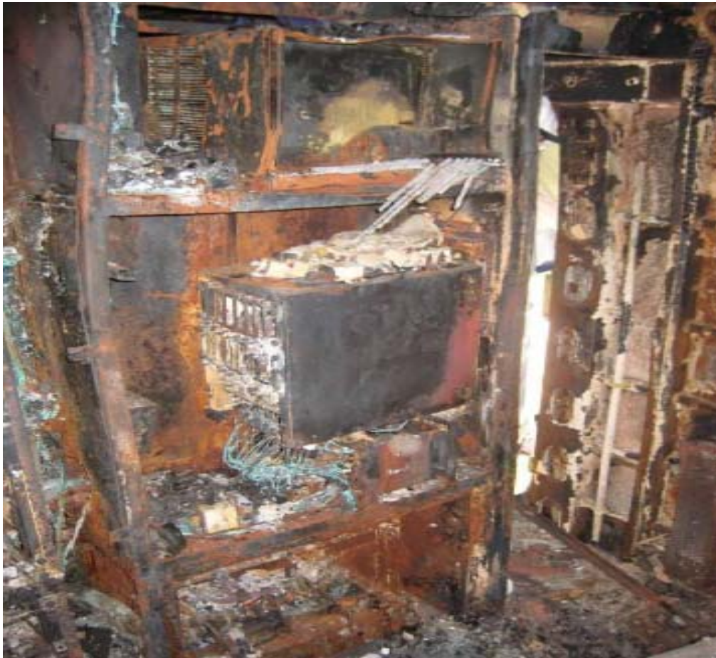
Abb. 10 Führerstand 1 Rückwand links mit Klimagerät, Umformerregergerät und Fahrmotorklemmstelle 1
