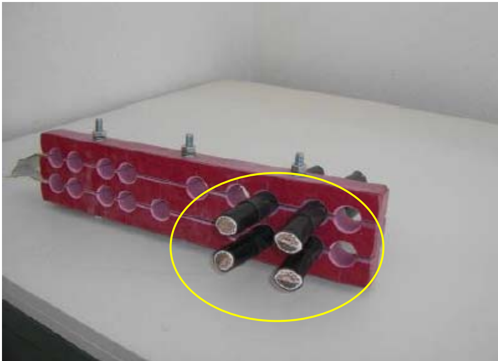
Abb. 17 Klemmstück mit Fahrmotorkabeln und Schrumpfschläuchen
